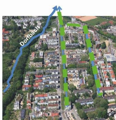
Entwässerung: modifiziertes Trennsystem mit Regenwasserversickerung über Mulden-Rigolen-Elemente, erbaut: 1997 - 2004
